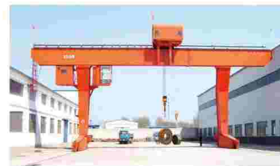
► L type gantry crane
