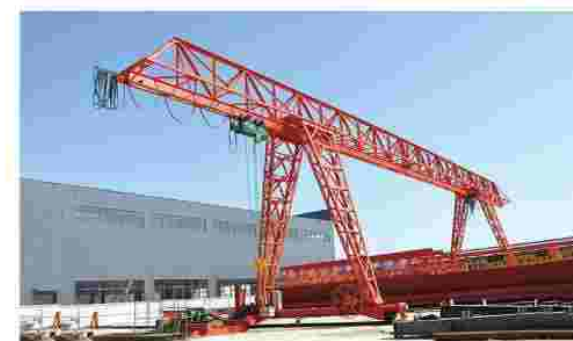
► MG type truss gantry crane
