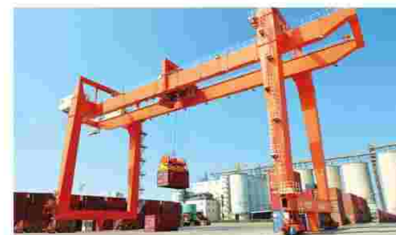
► Container gantry crane
